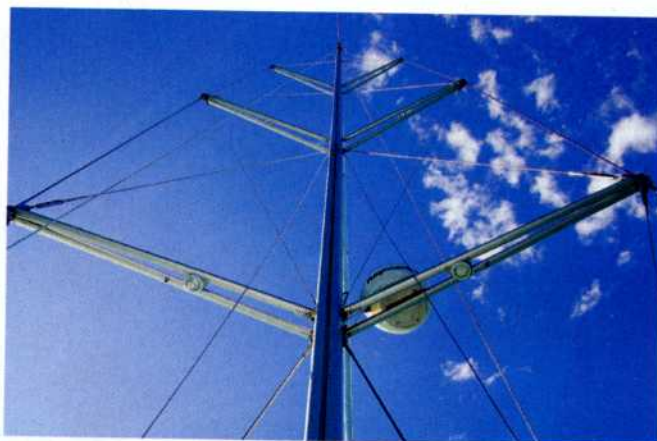
L'incrocio delle sartie intermedie permette un profilo dell'albero più sottile ma rende più complessa la messa a punto dell'armo.
